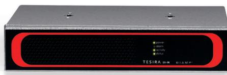
Tesira EX-IN、EX-OUT、EX-IO は Tesira SERVER や SERVER-IO と併用するのハーフラック拡張ユニットです。それぞれの拡張ユニットにはアナログ音声合計 4 チャンネルあります。EX-IN は 4 チャンネルのマイク / ライン入力拡張ユニット、EX-OUT は 4 チャンネルのマイク / ラインレベル出力拡張ユニット、EX-IO は 2 チャンネルのマイク / ラインレベル入力と 2 チャンネルのマイク / ライン出力を提供します。どの拡張ユニットも音声、コンフィギュレーション、コントロールを Tesira AVB ネットワークで送受信します。電源は PoE+ で供給されます。
